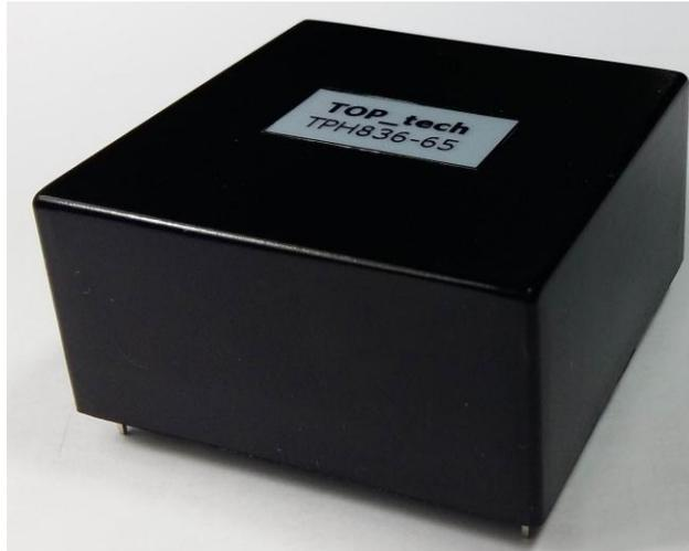
TPH836-17 专为 600V 至 1700V 的 IGBT 驱动设计, TPH836-33 专为 3300V 和 4000V 的 IGBT 驱动设计, TPH836-65 专为 6500V 高压 IGBT 驱动设计, 支持 IGBT 串并联工作模式。TPH836-X 具有驱动功率大(8W/±36A)、绝缘电压高、设计精巧、功能齐全, 使用方便等特点。
