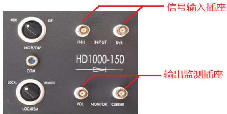
图 4 输入及检测面板
